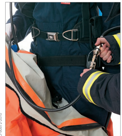
Conexión del semiautónomo al equipo de respiración autónomo en el interior del traje
